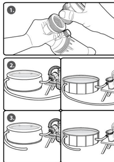
**Installieren des Chlorspenders zum Filtersystem**
