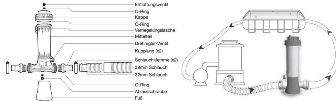
Ihr neuer Chlorspender ist entworfen um eingebaut zu werden im Rücklauf zu einem oberirdischen Pool mit einem Filtersystem mit als Standard einem 32mm oder 38mm Soft-Schlauchanschluss.
