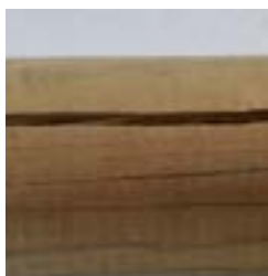
Cracks/Grietas/Fente/Risse/ Crepe/ Barsten/Fendas
