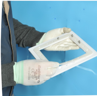
Setzen Sie die Dichtung auf den Flansch
