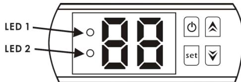
Cuando la bomba de calor está funcionando, la pantalla LED muestra la temperatura del agua de entrada.
