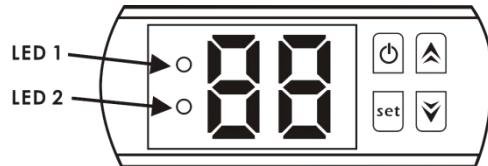
**Quando a bomba de calor está em funcionamento, o visor LED mostra a temperatura da água de entrada.**
