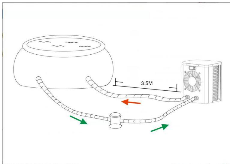
**ATTENZIONE:** Mai installare l'unità in una stanza chiusa con un volume d'aria limitato in cui l'aria espulsa dall'unità venga riutilizzata, o in prossimità di siepi che potrebbero bloccare l'entrata dell'aria. Tali posizioni compromettono la fornitura continuativa di aria pulita, avendo come risultanza una ridotta efficienza e impedendo potenzialmente una sufficiente produzione di calore.
