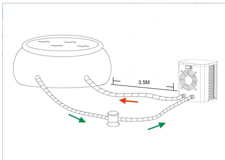
**ATTENTION :** L'unité ne doit pas être installée dans une zone où la ventilation d'air est limitée ou les emplacements qui ne peuvent pas fournir de façon continue de l'air, s'assurer que l'entrée d'air ne puisse jamais être obstruée. Les feuilles et autres débris peuvent se coller sur l'évaporateur, ce qui réduit son efficacité et affectera sa durée de vie.
