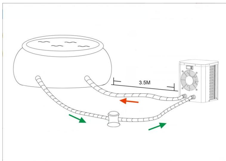
**ATENÇÃO:** Nunca instale a unidade numa sala fechada com um volume de ar limitado no qual o ar expulso da unidade será reutilizado, ou perto de arbustos que possam bloquear a entrada de ar. Tais locais prejudicam o fornecimento contínuo de ar fresco, resultando em eficiência reduzida e, possivelmente, impedindo a produção de calor suficiente.
