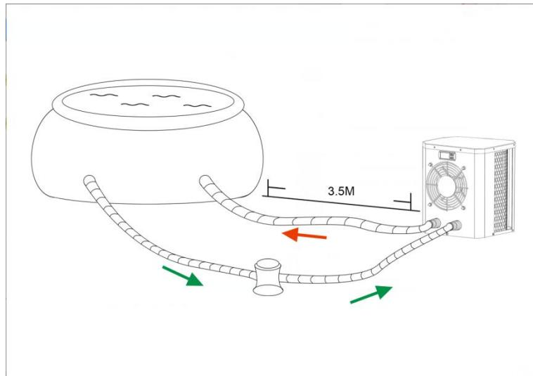
**ACHTUNG:** Installieren Sie das Gerät niemals in einem geschlossenen Raum mit einem begrenzten Luftvolumen, in dem die aus dem Gerät austretende Luft wiederverwendet wird, oder in der Nähe von Sträuchern, die den Lufteinlass blockieren könnten. Solche Stellen beeinträchtigen die kontinuierliche Frischluftzufuhr, was zu einem verminderten Wirkungsgrad führt und möglicherweise eine ausreichende Wärmeleistung verhindert.
