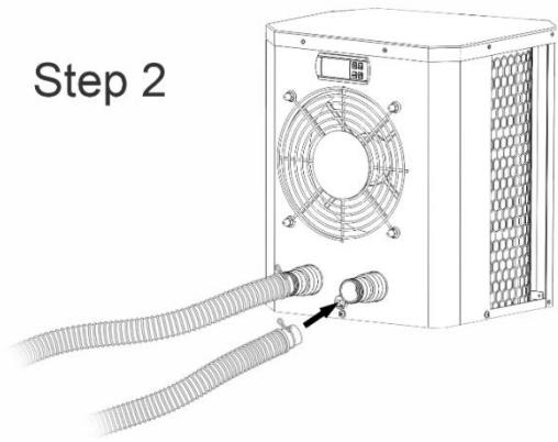
Nota: La fábrica sólo proporciona la unidad de la bomba de calor. Los otros elementos que se muestran en la ilustración, son las partes necesarias para su instalación son suministradas por los usuarios o las personas que realicen la instalación.
