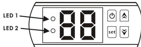
Mentre la pompa è in funzionamento, il display a LED mostra la temperatura dell'acqua in entrata.
