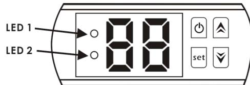
Wenn die Wärmepumpe läuft, dann zeigt der LED Bildschirm die Wassereintrittstemperatur.
