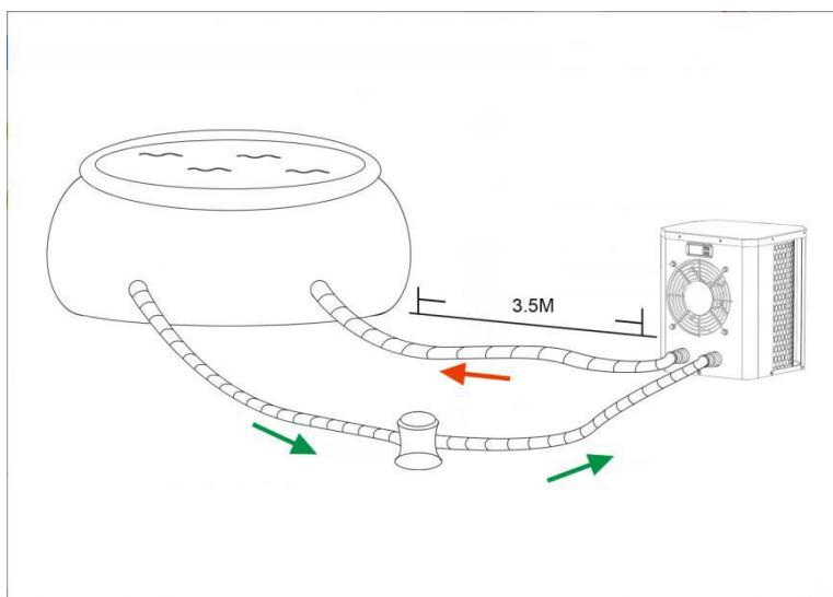
**ATTENTIE:** Installeer het apparaat nooit in een afgesloten ruimte met een gelimiteerde luchthoeveelheid in waarde lucht uitgestoten door het apparaat weer hergebruikt wordt, of nabij bosschage dat de luchtinlaat kan blokkeren. Zulke locaties verhinderen de continue levering van frisse lucht, wat resulteert in een gereduceerde efficiëncie en mogelijk voldoende warmte afgifte tegengaat.
