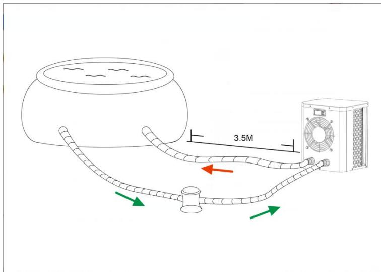
**ATENCIÓN:** La unidad no debe instalarse en una zona de aire de ventilación limitada, ni colocarse en un arbusto, que bloquearán la entrada de aire. Estas ubicaciones provocan que la unidad pueda recibir una fuente continua de aire fresco. Al cambio de las estaciones, también puede colmatar la batería evaporadora con las hojas de los arboles, lo que reducirá su eficiencia y afectaría a su vida útil.
