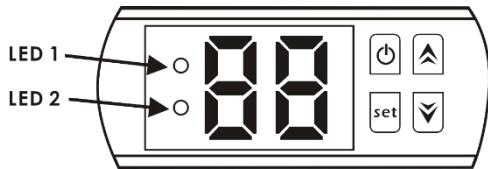
Lorsque la pompe à chaleur est en cours de fonctionnement, l'écran LED affichera la température d'arrivée d'eau.
